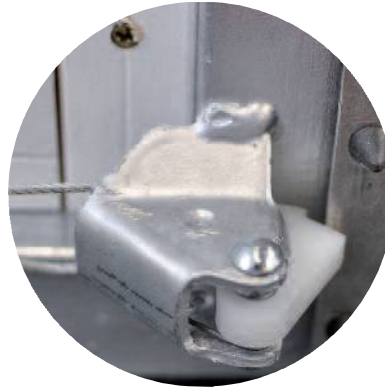
Die seitliche Verriegelung mit den Pfullendorfer Schließriegeln
